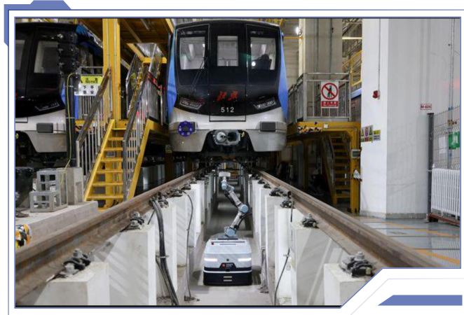
ARGO: 机车车辆的自主检查机器人
