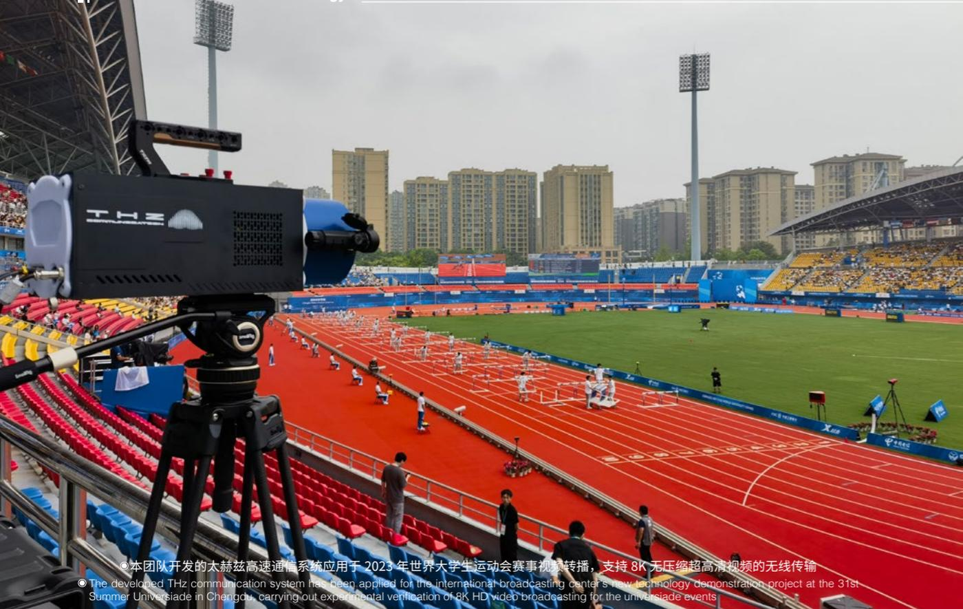
©本团队开发的太赫兹高速通信系统应用于2023年世界大学生运动会赛事视频转播，支持8K无压缩超高清视频的无线传输
