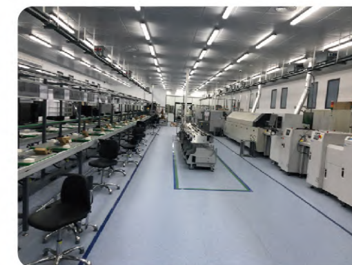
FiberHome阿尔及利亚工厂,左侧为组装生产线,右侧为SMT生产线
