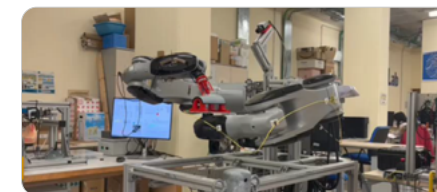
▲ 双手平台，显示机器人之间的协作任务，用于使用 FBG 光子技术压痕感应皮肤
